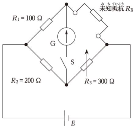
図のような回路をホイートストンブリッジ回路という。この回路において、検流計 G に流れる電流が 0A であるとき、抵抗  $R_1$ 、 $R_2$ 、 $R_3$ 、 $R_x$  の関係は、 $R_1 \cdot R_3 = R_2 \cdot R_x$  となる。よって、 $R_x$  の値は、
